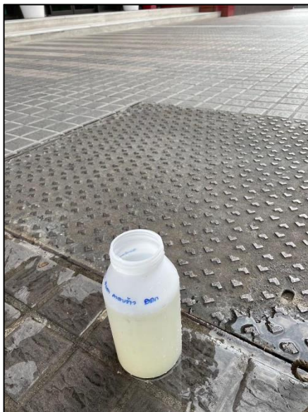
เก็บตัวอย่างน้ำทิ้งบริเวณจุดระบายน้ำออกจากกระบบบำบัดน้ำเสีย
