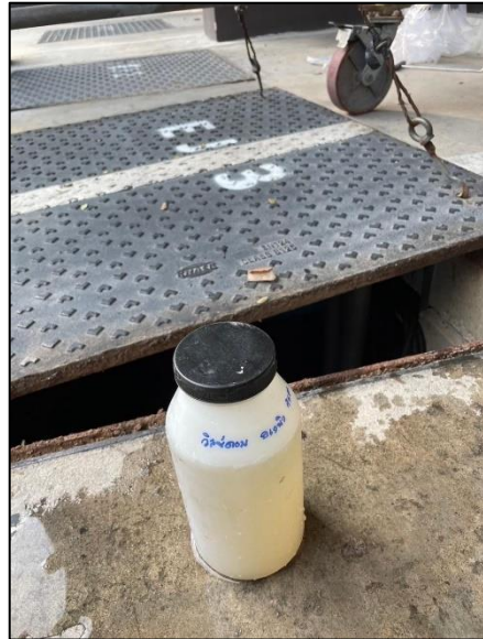
เก็บตัวอย่างน้ำเสียบริเวณจุดรวบรวมน้ำเสียเข้าระบบบำบัดน้ำเสีย
